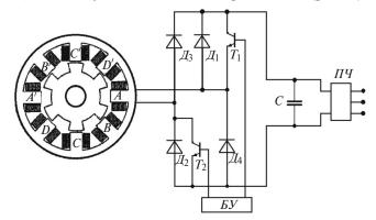
**Рис. 1.** Вентильно-индукторный генератор со схемой управления
