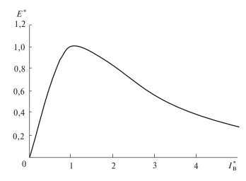
Рис. 6. Характеристика холостого хода классического индукторного генератора
