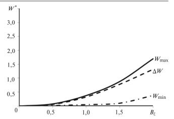
**Рис. 5.** Зависимости магнитной энергии зубцовой зоны индукторной машины от магнитной индукции в зубцах  $B_{\chi}$  (Тл) для  $\tau/\delta$  = 120
