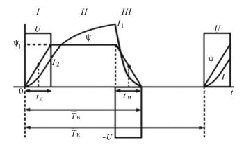
Рис. 2. Диаграмма токов, напряжений и потокосцепления генератора
