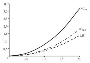
**Рис. 4.** Зависимости магнитной энергии зубцовой зоны индукторной машины от магнитной индукции в зубцах  $B_{\mathcal{Z}}$  (Тл) для  $\tau/\delta{=}8$
