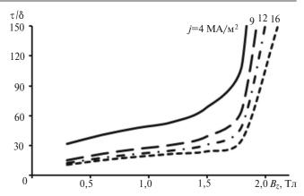
**Рис. 8.** Зависимости относительного значения зубцового деления  $\tau/\delta$  от магнитной индукции в зубцах  $B_{_{\mathcal{Z}}}$  и плотности тока в обмотке j ( $h_{_{\mathcal{T}}}/\tau$  = 2)
