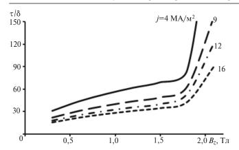
**Рис. 7.** Зависимости относительного значения зубцового деления  $\tau / \delta$  от магнитной индукции в зубцах  $B_z$  и плотности тока в обмотке j ( $h_z / \tau = 1$ )
