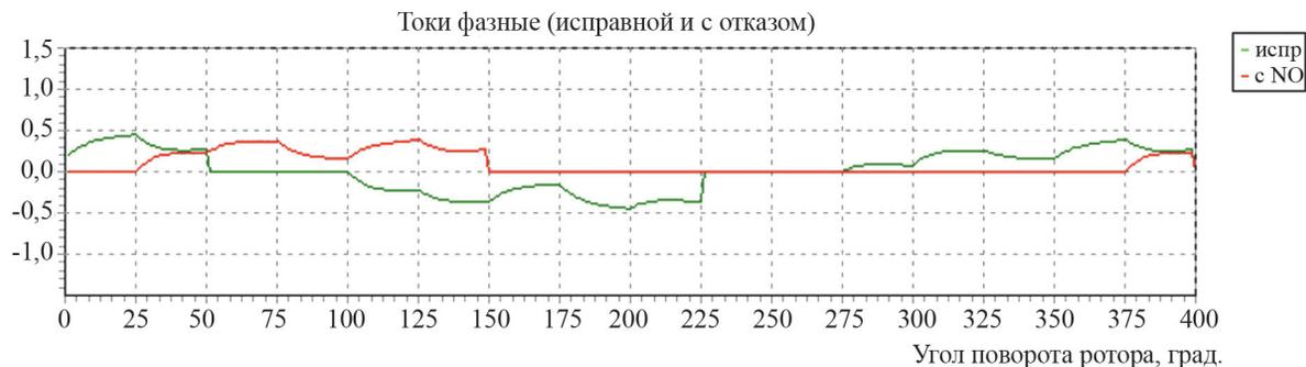
Мгновенные значения фазных координат на периоде повторяемости электромагнитных процессов семифазного вентильного двигателя при неполной коммутации пяти фаз
