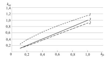
**Рис. 2.** Изменение амплитуды напряжения статора при регулировании на минимум потерь (кривая I), на постоянство перегрузочной способности (кривая 2) и на постоянство магнитного потока (кривая 3) при  $m_{\pi B} = -0.83$
