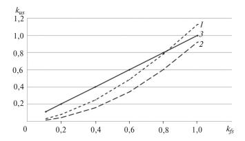
**Рис. 3.** Изменение амплитуды статорного напряжения при регулировании на минимум потерь (кривая I), на постоянство перегрузочной способности (кривая 2) и на постоянство магнитного потока (кривая 3) при вентиляторном характере движущего магнита  $m_{\rm ЛВ}=k_n\omega^2$
