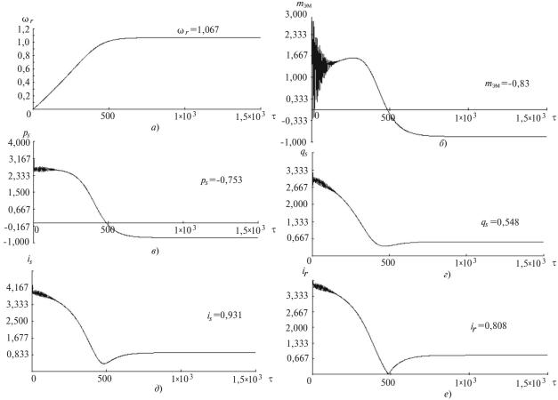
**Рис. 1.** Осциллограммы изменения режимных параметров асинхронной машины (серия 4A112M4), работающей в генераторном режиме
