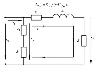
**Рис. 1.** Г-образная схема замещения одной фазы трансформатора
