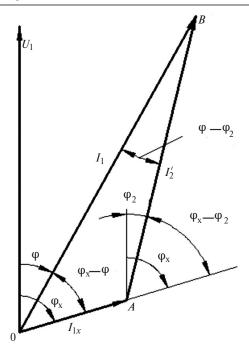
Рис. 2. Векторная диаграмма трансформатора
