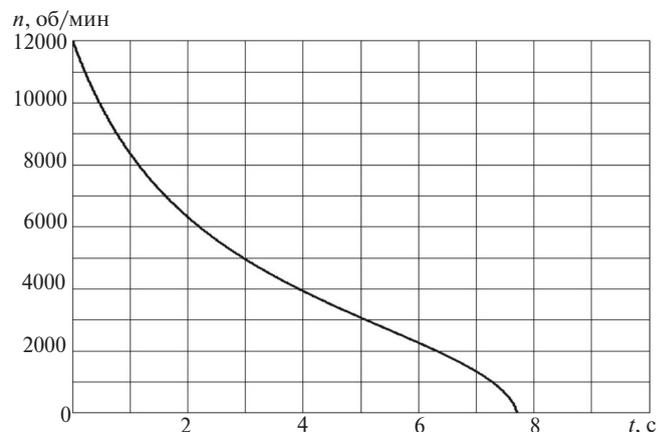
Рис. 6. Время выбега генератора с заполненной полостью ротора под действием трехфазного короткого замыкания
